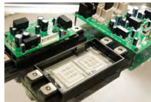
「パワー半導体」の他、様々な回路を基板上に集積した「インテリジェント・パワー・モジュール」。半導体の試作事業により、常に最新の技術に触れてきた点も、「パワー半導体」の製造を可能にする同社の技術力につながっている。
